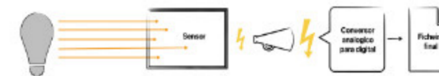
Fig. 3: O processo de formação de uma fotografia digital é transversal à generalidade das câmeras fotográficas no mercado. Um sensor é exposto à luz, a luz é transformada em eletricidade, a eletricidade passa por um amplificador que envia cargas voltaicas a um conversor de analógico para digital que faz corresponder estas voltagens a números.
